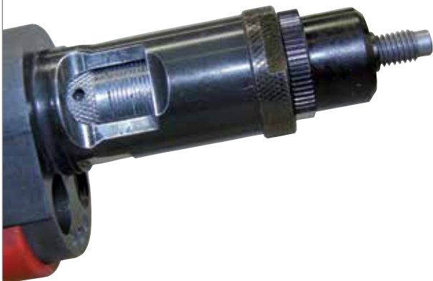
Zamontowany zestaw do przebrojenia
